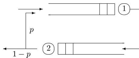
Les arrivées au réseau ci-dessus sont Poisson d'intensité  $\lambda$  et les services sont exponentiels de paramètre respectifs  $\mu_1$  et  $\mu_2$ . La quantité  $p$  désigne la probabilité de reboucler dans le réseau à la sortie de la file 2. La discipline de service aux files d'attente est FIFO.
