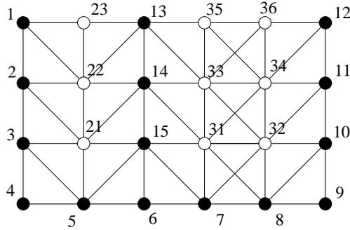
Figure 1: Un réseau avec une structure de grille augmentée de quelques liens. Les nœuds en noir font partie du CDS. (La numérotation des nœuds est choisie de sorte que l’algorithme de Wu et Li généralisé élide ce CDS.) Un réseau similaire peut être construit sur une grille  $6 \times h$  de hauteur quelconque.
